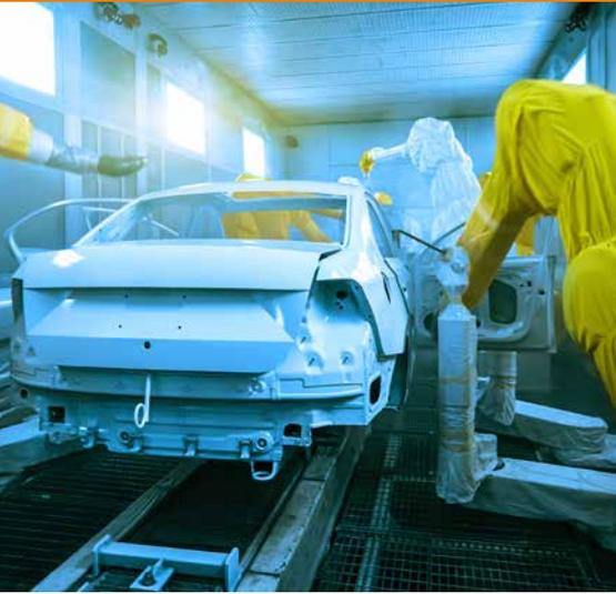
Die Lackiererei ist eine sensible Umgebung. Keine Fremdkörper dürfen den Lack verunreinigen und der Explosionsschutz muss auch beachtet werden. Hierbei spielen die verarbeiteten Lacke eine Rolle, aber auch mit den richtig konstruierten Werkzeugen und Maschinen kann man hier schon vorbeugen. Neben Energieketten aus besonders abriebarmem Material bieten wir deshalb auch mehrere Modelle aus leitfähigem ESD-Material an.
