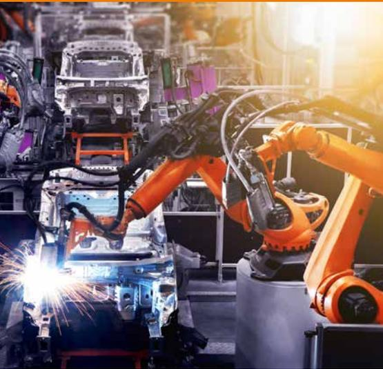
Die Prozessabläufe im Karosseriebau sind fließend. Steht ein Maschinenteil still, fällt die ganze Produktionsstraße aus. Um die elektrischen und pneumatischen Leitungen und Zufuhrschläuche der Roboter in der rotierenden Bewegung und vor Schweißfunken zu schützen, hat igus® die Energiekette triflex® entwickelt. Sie macht die Mehrachs-bewegungen spielend mit, ist leicht zu montieren oder Instand zu setzen und einfach anzupassen.
