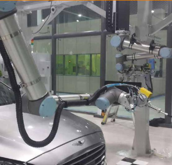
In der Endmontage gibt es den letzten Schliff in der Fertigungskette. Der Anspruch an störungsfreie Abläufe ist hier aber nicht weniger gering als zu Beginn der Produktion. Manipulatoren, die in diesem Schritt oft Menschen bei der Fertigung unterstützen, sollten leicht zu bewegen sein. Hier sind Energieketten aus Kunststoff, leicht aber robust, genau richtig. Mit unterstützenden Rollen können hier auch lange Wege stetig und verlässlich verfahren werden.
