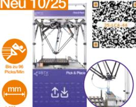
XXL 3-Achs-Delta-Roboter mit bis zu 96 Picks/min
