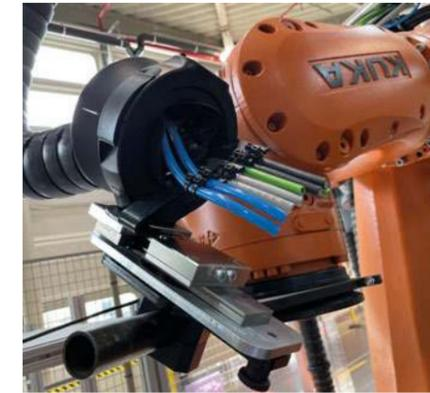
Die Sensoreinheit misst auftretende Zugkräfte mithilfe einer 200 kg-Wägezelle. Sie wird an der Schnellwechseleinheit für die Spannschelle Achse 6 montiert.
