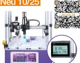
Portalroboter mit Siemens S7-Steuerung
