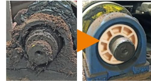
Kunststoffkalotten statt Metallkugellager Laufzeit erhöhen durch den Einsatz von kostengünstigen igubal® Lagereinsätzen – hier in einem Ziegelwerk
