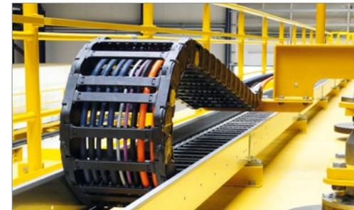
Rollen statt gleiten und dabei bis zu 37 % Antriebsleistung sparen. Für hohe Geschwindigkeiten bis zu 10 m/s und längere Wege bis zu 500 m.
