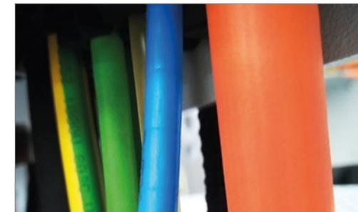
Keine Quetschungen an den Schläuchen nach Zugentlastung durch CFX-Schellen mit Pneumatikeinsätzen.
