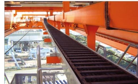
Krane in Hafenanlagen müssen Höchstleistungen bringen. igus® e-ketten® und flexible Leitungen sind genau dort im Einsatz.
