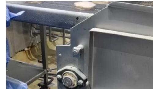
Kunststoffgehäuse mit gespritztem igubal® Lagereinsatz in einem Förderband für Lebensmittel
