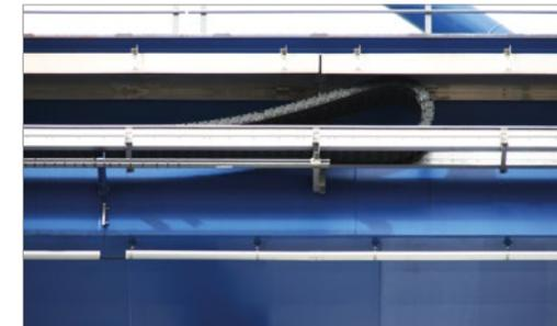
P4 Rollen e-ketten® für Anwendungen mit sehr hohen Geschwindigkeiten und Anlagen, bei denen besonders auf die Geräuschbelastung geachtet wird.
