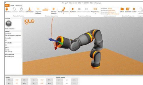
ReBeL® steuerbar mit der igus® Robot Control iRC, eine Steuerung für alle Roboter bis zu 16 Antriebe oder Greifer, Kamera, etc
