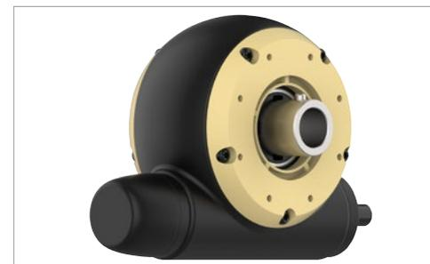
**Direkte Anbindung an drylin® Antriebstechnik:** Über einen Adapter können Apiro® Getriebe direkt am Abtriebszapfen von drylin® SHT- und SLW-Linearmodulen montiert werden. Dank dieses Aufbaus können drylin® Systeme synchronisiert und mehrere Apiro® Getriebe in Reihe geschaltet werden.
