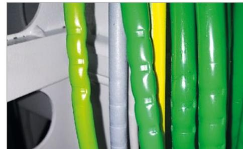
Quetschungen an den Schläuchen nach Zugentlastung durch Standard-Bügelschellen.
