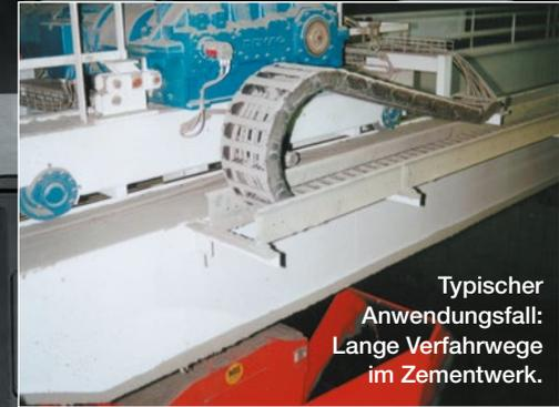
Typischer Anwendungsfall: Lange Verfahrswege im Zementwerk.
