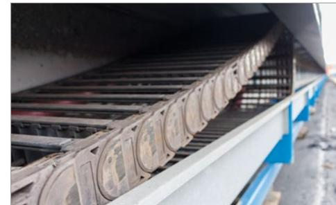
Rollen e-ketten® sind sicher, platzsparend und sehr wartungsarm. Kabellängen können um bis zu 50 % eingespart werden (im Vergleich zu Feststoes).
