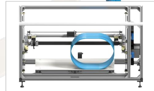
Riesige Bauteile in einem 3D-Druckvorgang von bis zu 3 Metern aus iglidur® I150 und iglidur® I151
