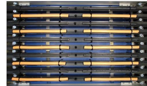
Tests im igus® Labor: Verschiedene Gleitpartner werden auf Abrieb getestet und bewertet.
