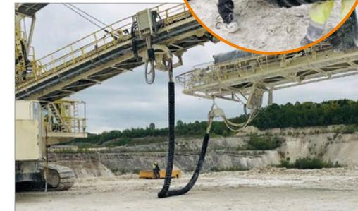
Der e-loop® kommt im Schaufelradbagger der Firma Holcim (Deutschland) GmbH zum Einsatz. Das modulare System aus Hochleistungskunststoff bietet zu jeder Zeit einen definierten Biegeradius und hält Vibrationen und Schlägen stand.
