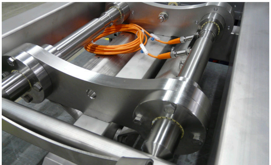
GEA setzt in den Folienumlenkrollen seiner Thermoform-Verpackungsanlagen xiros F180-Kunststoffkugellager ein. Unten: Die wartungsfreie automatische Bahnkantenregelung mit drylin-Trapezgewindemutter und drylin-R-Linearfolien schafft die Voraussetzung für die Verarbeitung diverser Folienqualitäten.
