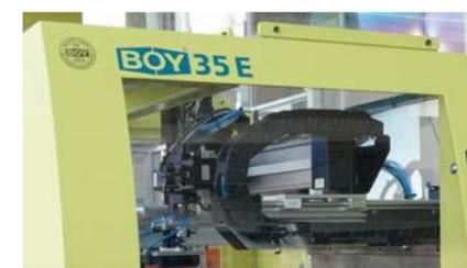
**Portalroboter für automatisiertes Teilehandling in einer Spritzgussmaschine: ab 9.026 €**
