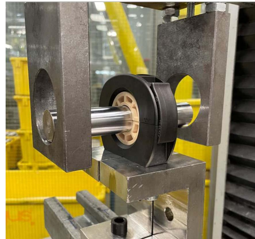
Das Stehlager mit Schnellverschluss im Zugversuch.
