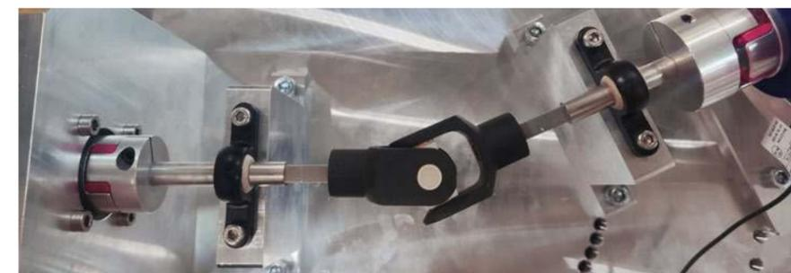
Das UJM-Kardangelenk im Test bei 25° Auslenkung.
