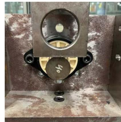
Das geteilte PTFE-freie igubal® Flanschlager aus igumid® G und iglidur® J3 im Drucktest.
