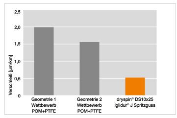
Verschleiß nach 630.000 Zyklen, Hub 140 mm, 100 U/min, Last 200 N, keine Schmierung
