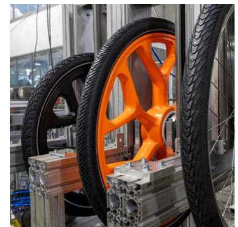
Auf diesem Prüfstand rollen die Laufräder über Kanten und werden zusätzlich von oben belastet.
