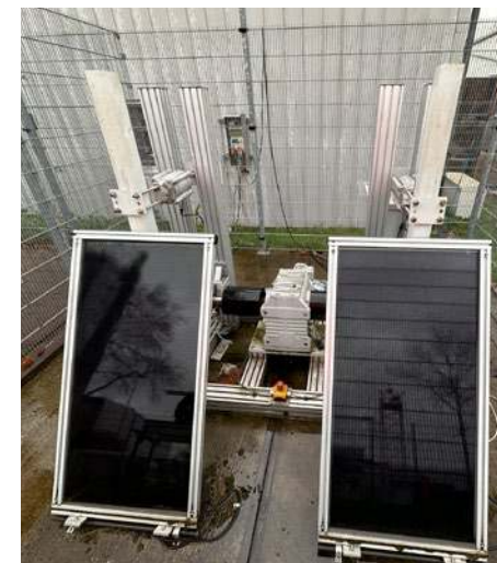
Unser ESQM-2.0-Stehlager im igus® Outdoor-Testlabor.
