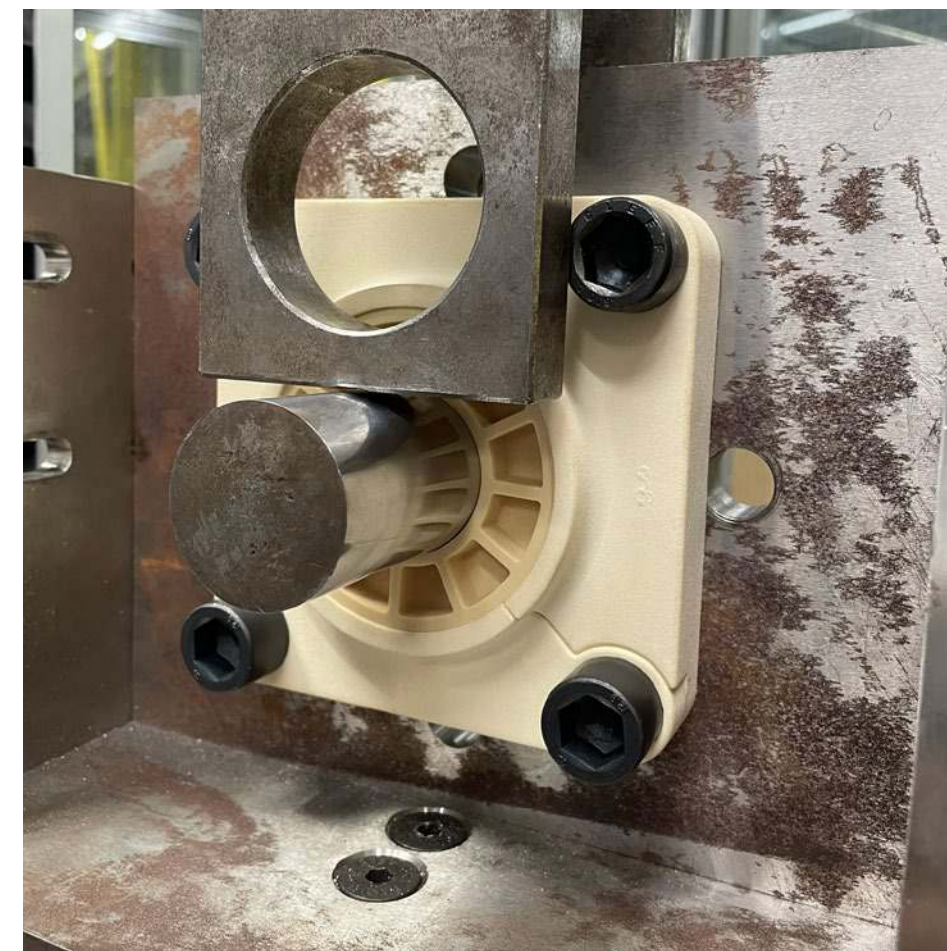
Statische Lastaufnahme bis zu 14,8kN, selbst bei 3D-gedruckten Teilen.
