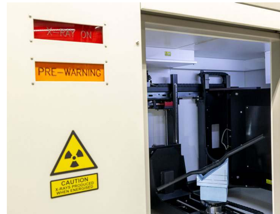
Per Röntgengerät werden die Spritzgusskomponenten untersucht, um eventuelle Fehler auszuschließen.
