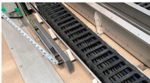
EC.PPセンサー設置P4.1エネルギーチェーンのイグス屋外試験装置(左図) およびスマートプラスチックモジュール設置の制御キャビネット(右図)
