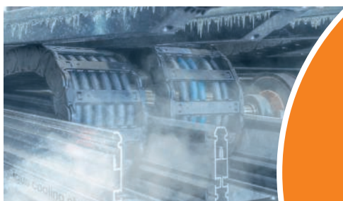
環境試験室。低温環境下でのエネルギーチェーン動作テスト、-40℃環境
